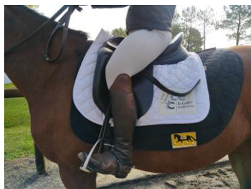
Figure 1 : Nappe de pression Tekscan (tapis noir) placée sous un tapis coton (blanc)
